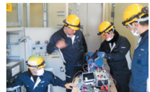
継電器の精密試験
