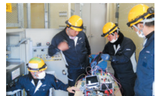
継電器の精密試験
